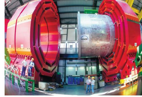
Los aceleradores utilizan altos campos eléctricos para acelerar los haces de partículas, y campos magnéticos para guiarlos. Los aceleradores más grandes son circulares y utilizan potentes campos magnéticos para hacer girar las partículas dentro del anillo. Estas adquieren en cada vuelta energía adicional.
