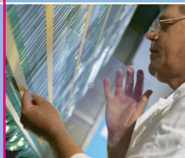
Para identificar las partículas, el detector Cherenkov de focalización anular utilizará la luz Cherenkov, una radiación emitida por las partículas cargadas cuando se mueven en un material a velocidades superiores a la de la luz en ese material.
