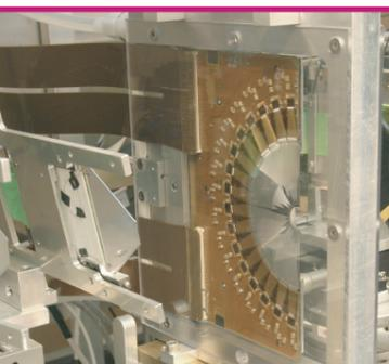
El calorímetro hadrónico medirá la energía de las partículas. Consiste en una estructura de 500 toneladas formada por placas de hierro y plástico centelleador que se alternan y superponen como las tejas en un tejado.
