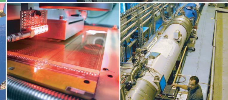
El detector de vértice registrará la trayectoria de las partículas muy cerca del punto de colisión, con una precisión de 10 micrómetros, para detectar las desintegraciones de las partículas que contengan quarks y antiquarks belleza.
