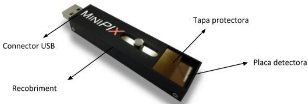
Fig. 1 Parts que conformen el detector Medipix
