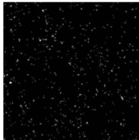
Ejemplo de los píxeles ocupados en una medida de 1h solamente con la radiación de fondo
