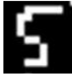
Figura 12: partícula beta detectada amb el TimePix. Font pròpia.
